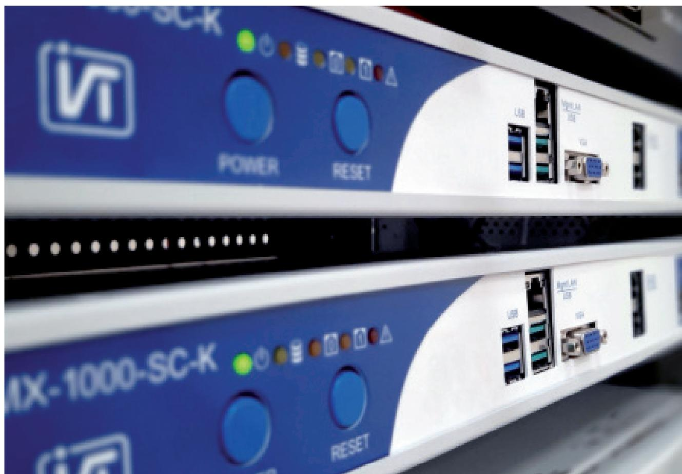
Softswitch МиниКом МХ-1000 обеспечивает передачу данных между сервисами IP-телефонии, телефонных сетей общего пользования, цифровых сетей интегрального обслуживания, интеллектуальных сетей, сетей мобильной связи и всемирной сети Интернет.
