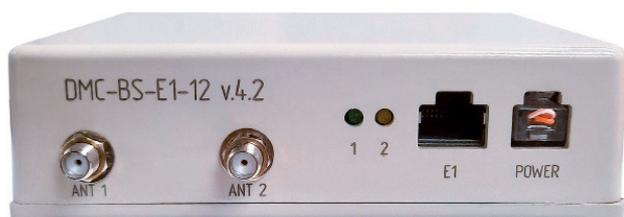
Базовая станция предназначена для установки в отапливаемом помещении, интервал рабочих температур +5...+40 °С;
